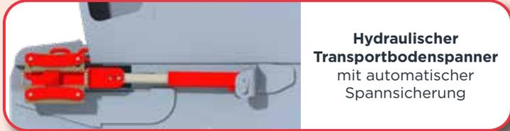
**Hydraulischer Transportbodenspanner** mit automatischer Spannsicherung
