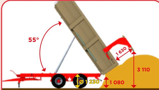
**Hydraulische Heckklappe mit großem Öffnungswinkel**, um das Entladen von Silage mit Aufsätzen zu erleichtern und das Abkratzen des Haufens beim Kippen zu vermeiden.
