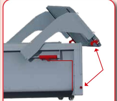
**Öffnungszyylinder der Heckklappe**, die durch den Türarm und den oberen Kastenrahmen geschützt sind.
