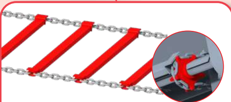
Rohrleisten geschweißt auf Schiffsketten 14 (zur Verhinderung von Materialablagerung) + maschinengeschweißte Antriebsnüsse.
