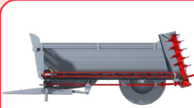
Antriebsstrang mit Getriebe unter der tiefergelegten Achse (ideal für Hanglagen).
