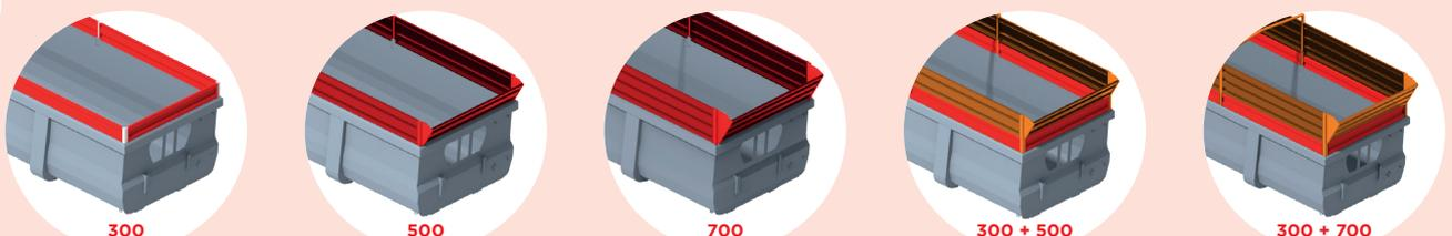
**Aufsätze von 300** (Stahl oder Aluminium), **500** (Aluminium) oder **700 mm** (Aluminium) sind kombinierbar bis zu einer Gesamthöhe von 1 m. Um das Gewicht einzugrenzen und die Montage durch eine Person zu erleichtern, gibt es zweiteilige Seitenaufsätze bei ein- und zweiachsigen Modellen und dreiteilige bei dreiachsigen Modellen.
