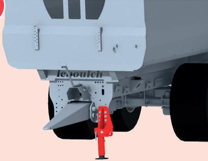
**Hydraulisch einklappbarer Stützfuß**, der direkt am Fahrgestell befestigt ist, um die Deichsel freizugeben und den Lenkeinschlag zu begünstigen.
