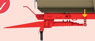
**Deichselfederung** mit einstellbarer Längsfeder (3 Positionen).
