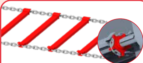
Barras tubulares soldadas a cadenas marinas 14 (para evitar el almacenamiento de material) + piñones de arrastre soldados mecánicamente.
