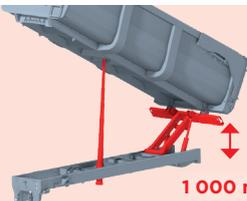
**Remolque semielevador** para facilitar el vaciado a gran altura de productos a granel.
