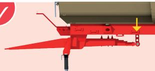
**Suspensión de la lanza** con resorte longitudinal ajustable (3 posiciones).
