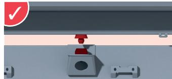
**Silentblock anti-ruído** de centrado y bloqueo lateral de la caja en el bastidor.
