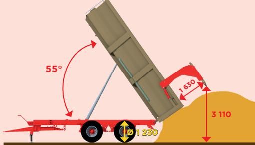
**Puerta trasera de gran despeje con apertura hidráulica** para facilitar la descarga del ensilado con realce y evitar el raspado de la pila durante el vuelco máximo.
