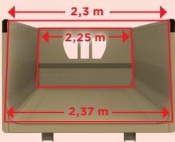
**Caja cónica** (2,25 m en la parte delantera y 2,3 m en la trasera), más ancha en la parte inferior que en la superior para facilitar la descarga.
