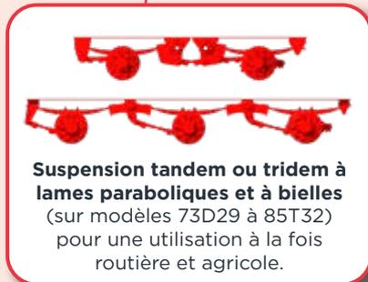
**Suspension tandem ou tridem à lames paraboliques et à bielles** (sur modèles 73D29 à 85T32) pour une utilisation à la fois routière et agricole.
