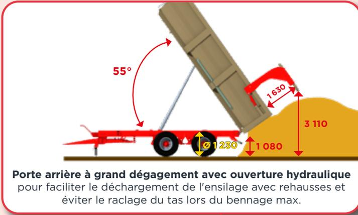
**Porte arrière à grand dégagement avec ouverture hydraulique** pour faciliter le déchargement de l'ensilage avec rehausses et éviter le raclage du tas lors du bennage max.
