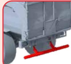
**Pare-chocs arrière** galvanisé et réglable en hauteur et en profondeur.
