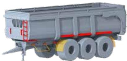
Échelle escamotable en aluminium, garde-boue latéraux galvanisés et prédispositions pour équipements optionnels (pare-cycliste et garde-boue thermoplastiques).
