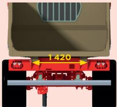
**Articulation de bennage placée au maximum à l'arrière** pour être le plus haut possible au bennage.
