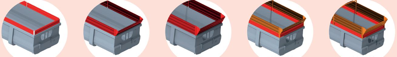
**Rehausse de 300** (acier ou aluminium), **500** (aluminium) ou **700** mm (aluminium), cumulables jusqu'à 1 m.
