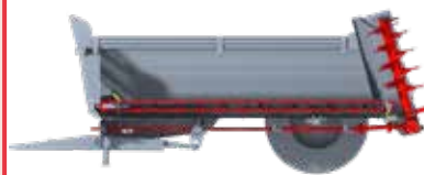
Aandrijflijn met overbrenging onder de verlaagde as (ideaal voor hellingen).
