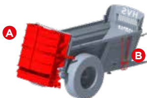
(A) Osłona z drzwiami 2-skrzydłowymi (B) Drabinka dająca wgląd do wnętrza skrzyni
